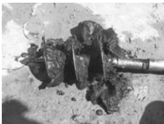
FOTO 2. Accesorio especial para la eliminación de arena de las tuberías
