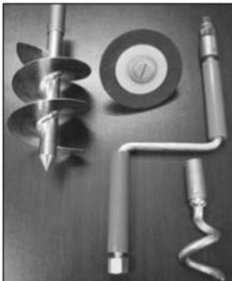
FOTO 1. Accesorios para limpieza, usados conectados a varillas de acción mecánica
